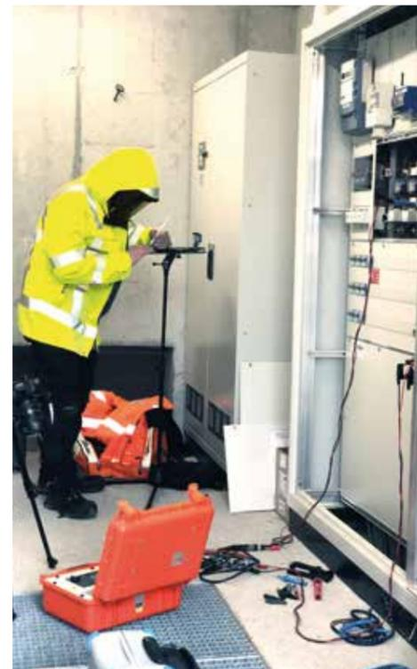
Da es uns auch v.a. um das gewählte Messzubehör ging, haben wir verschiedene Anschlussmethoden angewendet und die Messung mit derselben Messleitung und demselben Zubehör unter denselben Bedingungen durchgeführt.
