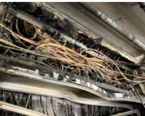
Unfall- und Schadenbild nach dem Ereignis: Schwere Brandverletzungen an der linken Hand und vollständig abgebrannte HV.
