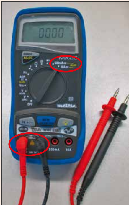
Multimeter Einstellung Funktionsschalter auf Strom und Buchsen auf Spannung:
