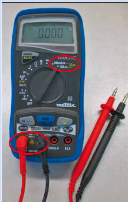
Multimètre Réglage du commutateur de fonction sur courant et douilles sur tension :
