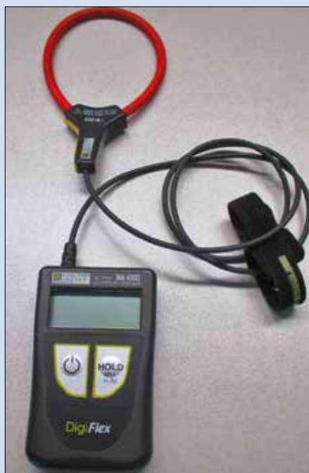
Transformateur Flex pour mesurer sans danger jusqu'à 4000 A ; Cat. IV.
