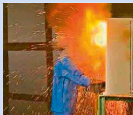
Les nouveaux gants isolants de catégorie II 7 kA et 1000 V qui ont été testés.
