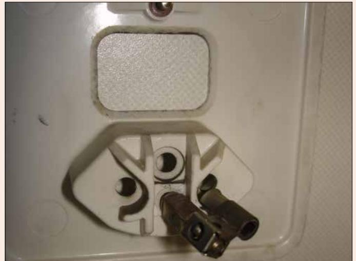
Anschlussklemme des Schutzleiters verbunden hatte, ist gebrochen. Die Schutzleiterbuchse wurde nur noch durch den Druck der Abdeckplatte festgehalten.
